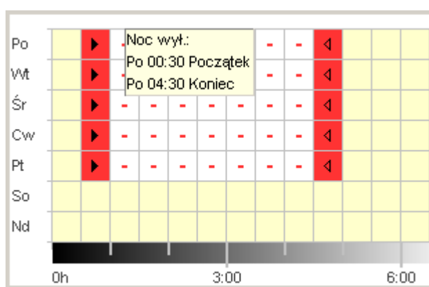
Rys. 55: Wyłączenia oświetlenia ulicznego w dni robocze
